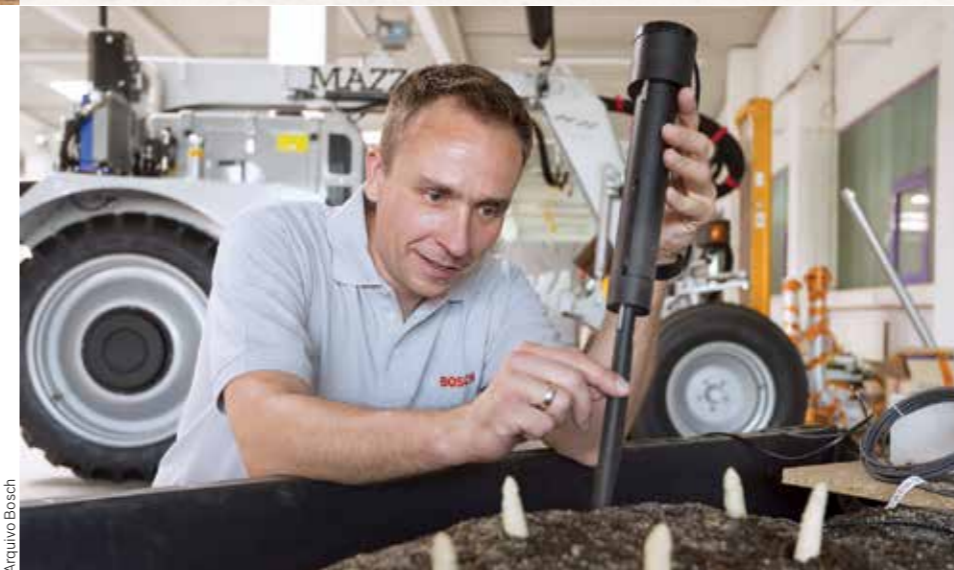
Em regiões desérticas, é comum o uso de sensores que permitem o monitoramento da temperatura e umidade do solo
